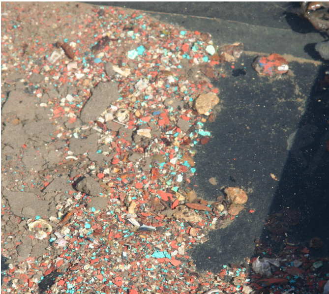
Image 8 : Paillettes de peinture antifouling présentes sur le tapis de carénage - © Gilbert PLOE
