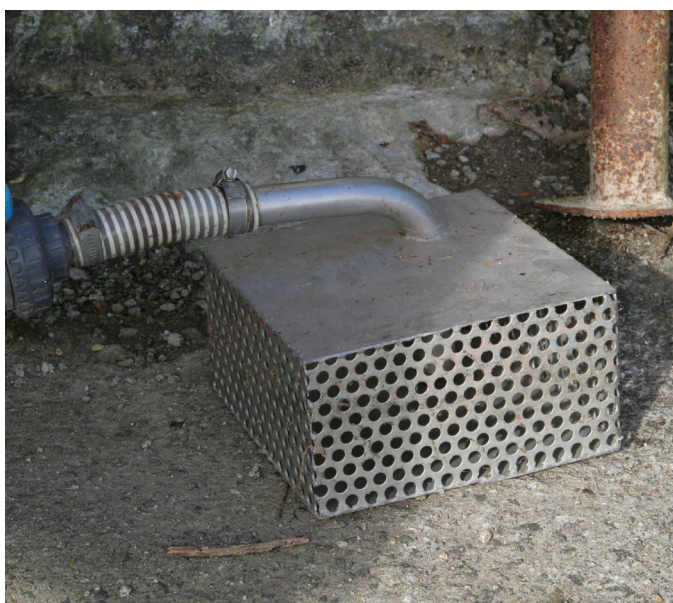
Image 3 : Crépine permettant un premier filtrage des eaux sales issues d'un carénage - © Gilbert PLOE
